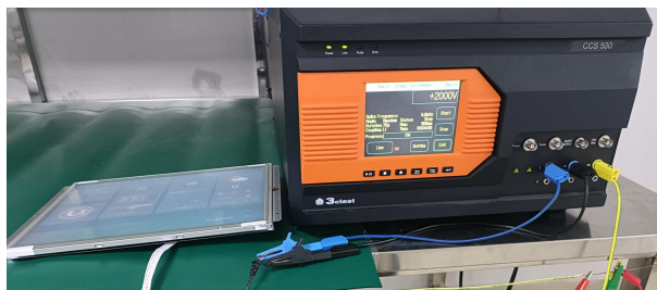
3.2 群脉冲测试图 EFT test
